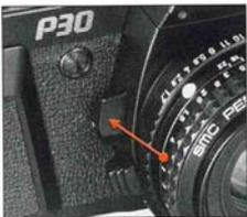
Mit Ihrer Kamera können Sie die Schärfentiefe kontrollieren. Dazu dient der Schärfentiefehebel. Wenn Sie den Hebel eindrücken, dann wird die Blende auf den vorher eingestellten Wert geschlossen. So können Sie auf der Mattscheibe sehen, was alles im Vorder- und Hintergrund scharf abgebildet wird. Die Kontrolle der Schärfentiefe ist nur möglich bei der Nachführmessung. Sobald Sie den Hebel loslassen, öffnet sich die Blende wieder.
